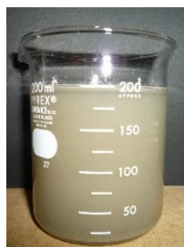
処理前（セメント洗淨水）
